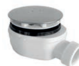
SE940 Vaničkový sifon Ø 90 mm odpad 40 mm, extra nízký výška 51 mm, suchá uzávěra krytka nerez 545,- / 21,30 €
